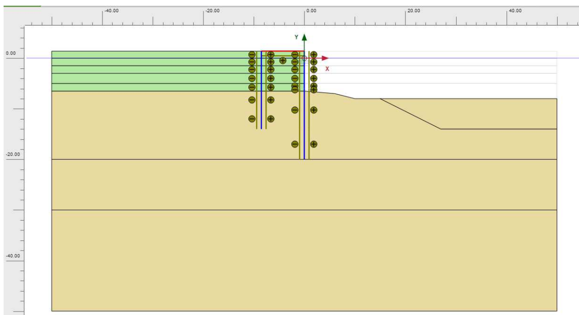
Figura 44 – Fase 3 - Infissione paratia di ancoraggio e getto solettone in c.a.
