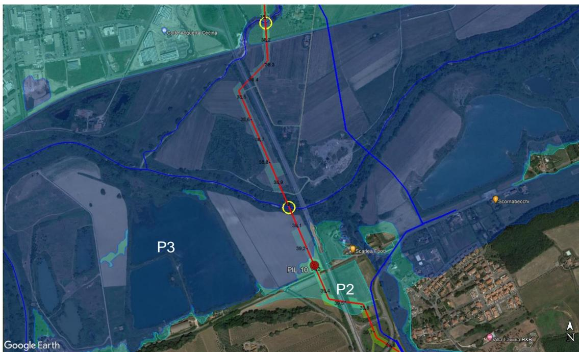
**Fig. 4.3/D - Ubicazione del punto di linea PIL n.10 (km 39,280). La distanza minima del PIL n.10 (p.c. 9,40 m s.l.m.) dal fiume Cecina è di circa 240 m.**
