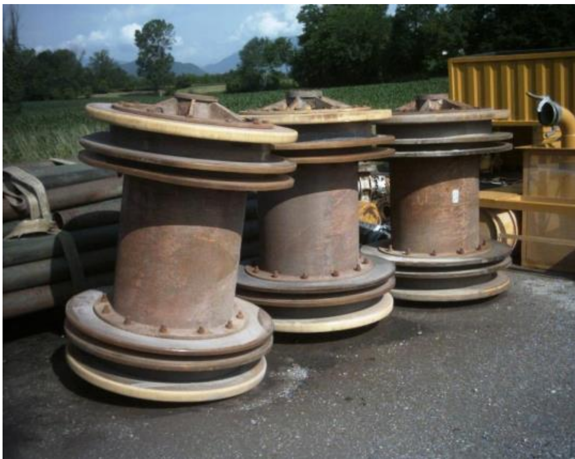
Foto 3.3.8.1/B - Pig per collaudo idraulico
