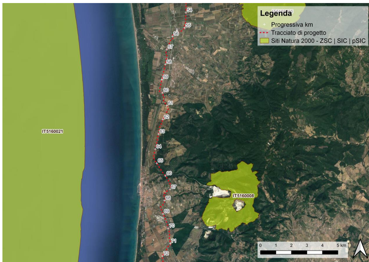
Fig. 5.5.2.1/E - Dettaglio delle relazioni spaziali fra Rete Natura 2000 (IT5160008 Monte Calvi di Campiglia) e tracciato (area centro sud)
