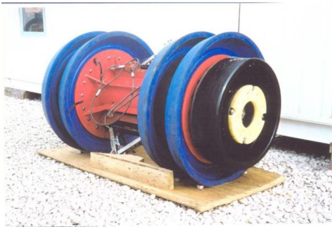
Foto 3.3.9.2/B - Pig strumentale per il controllo della geometria e dello spessore della condotta
