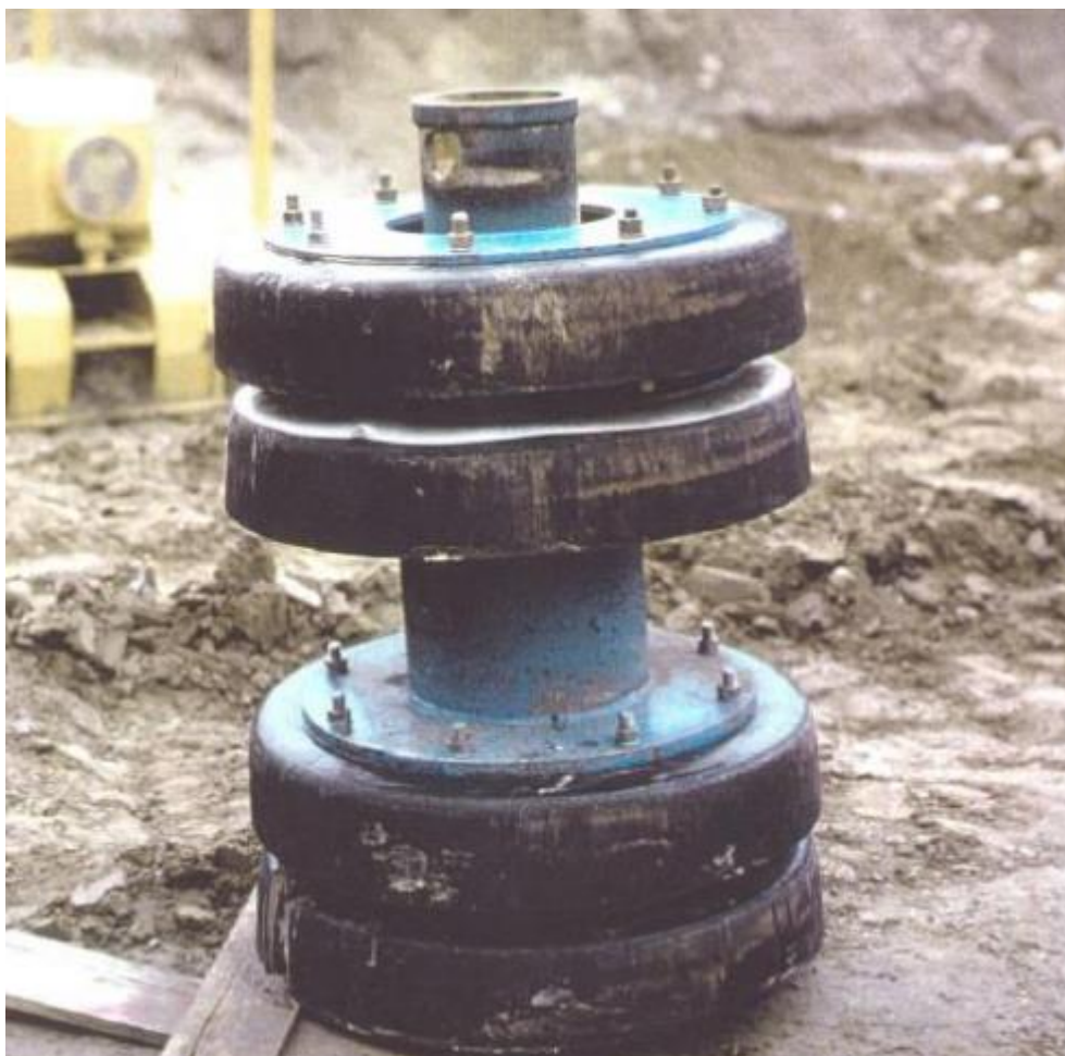
Foto 3.3.9.2/A - Pig convenzionale impiegato nelle operazioni di collaudo idraulico e di pulizia della condotta
