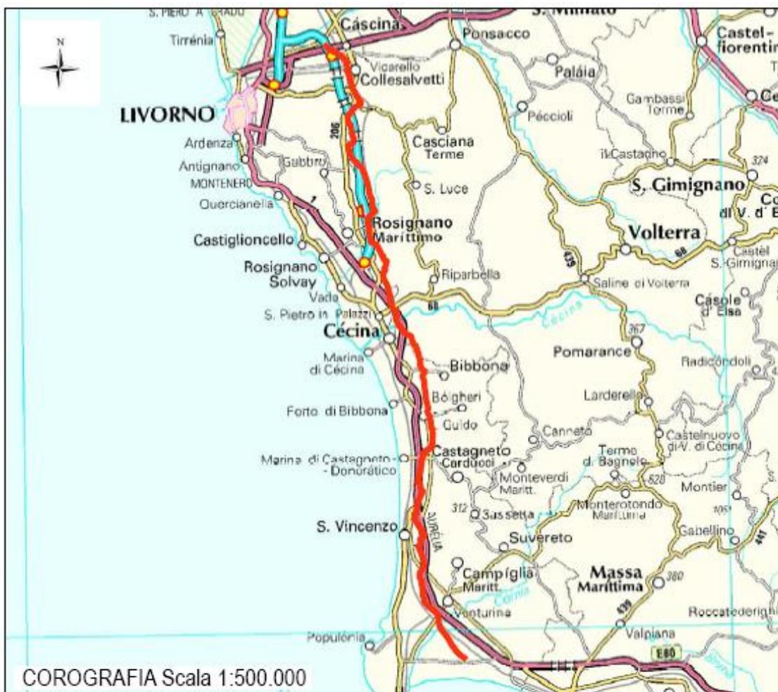
Figura 1 – Corografia di progetto – la linea rossa rappresenta il tracciato del metanodotto in progetto
