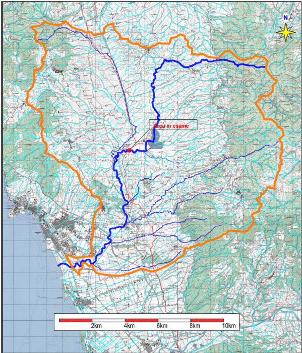
Fig.6.2/A: Bacino complessivo del fiume Fine con indicazione dell'ambito di attraversamento
