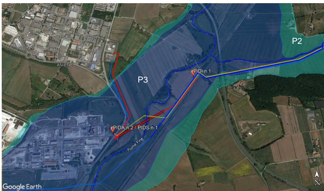
Fig.2.3/H: Ubicazione dei punti di linea PIDI n.1 (km 0,000), quota p.c. 9,20 m s.l.m., distanza minima dal fiume Fine di circa 90 m, e PIDA n.2 (km 0,820) / PIDS n.1 (km 0,000), quota p.c. 7,50 m s.l.m., distanza minima dal fiume Fine di circa 140 m.
