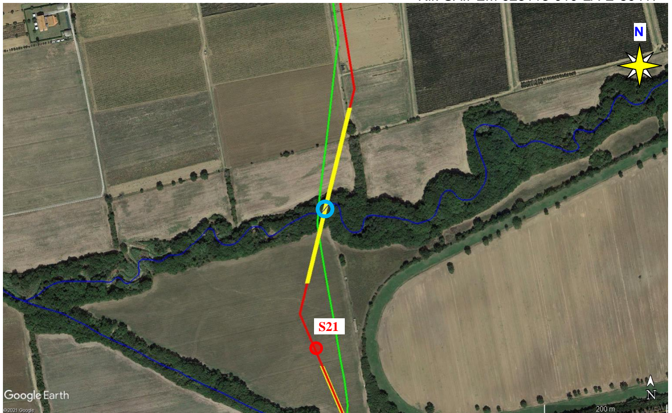
Fig.3.3/A: Foto aerea dell'ambito di attraversamento, con ubicazione del sondaggio geognostico
