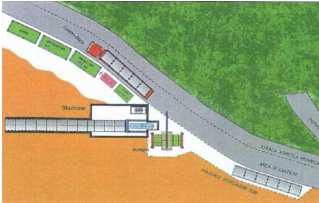
Fig. 5/G - Schema tipo di un cantiere per l'installazione di un microtunnel
