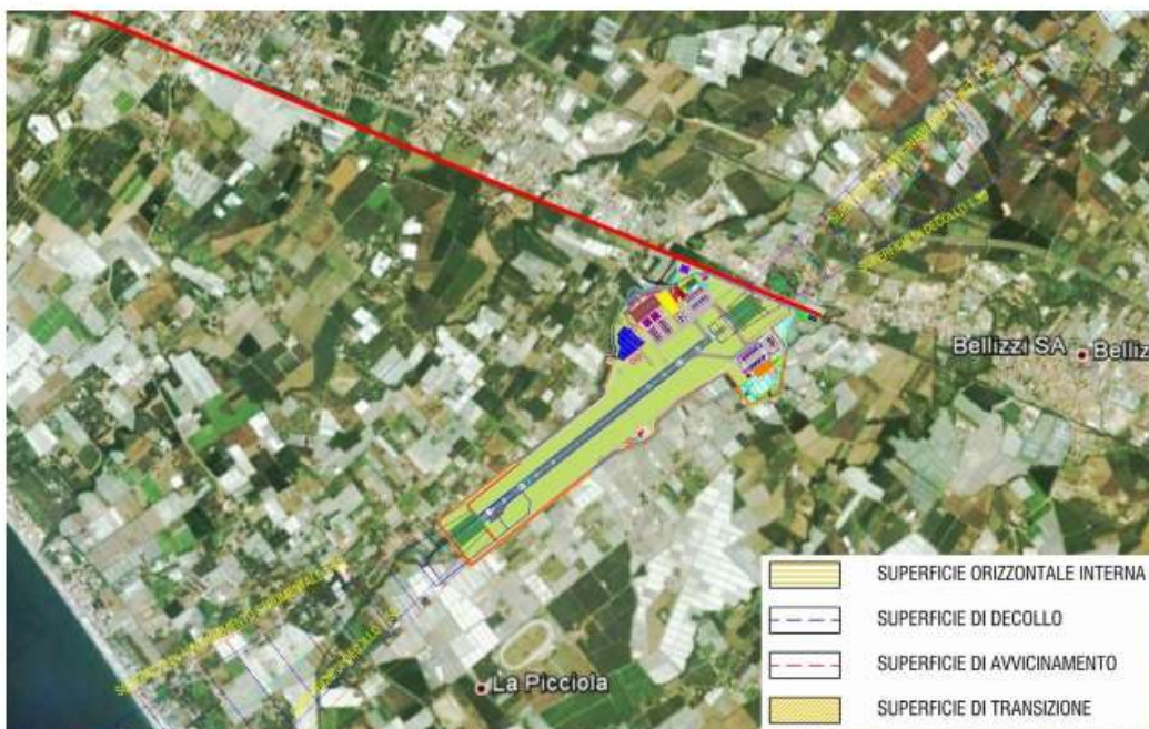
Figura 4-5 Stralcio della tavola di Masterplan "Superfici di limitazione ostacoli - Fase 2 e Massimo Sviluppo - Pista 2.200 mt" (in rosso la linea metropolitana oggetto di intervento)
