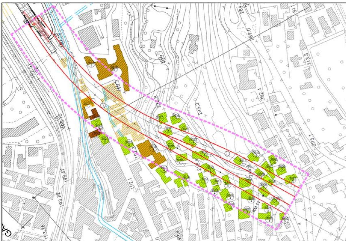
Figura 26 Bivio Trento Nord, imbocco galleria – Fascia di potenziale disturbo da vibrazioni ferroviarie nella condizione di singolo transito di un treno merci
