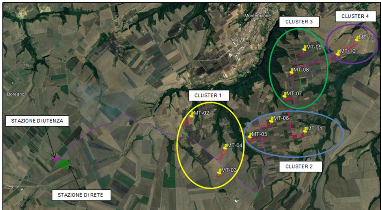
Figura 18 - Layout preliminare cavidotti
