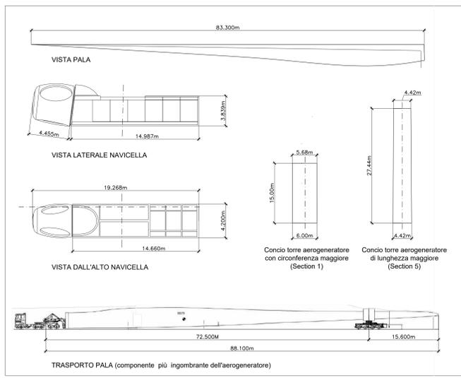
**DIMENSIONI MASSIME DELLE PARTI COMPONENTI L'AEROGENERATORE**
