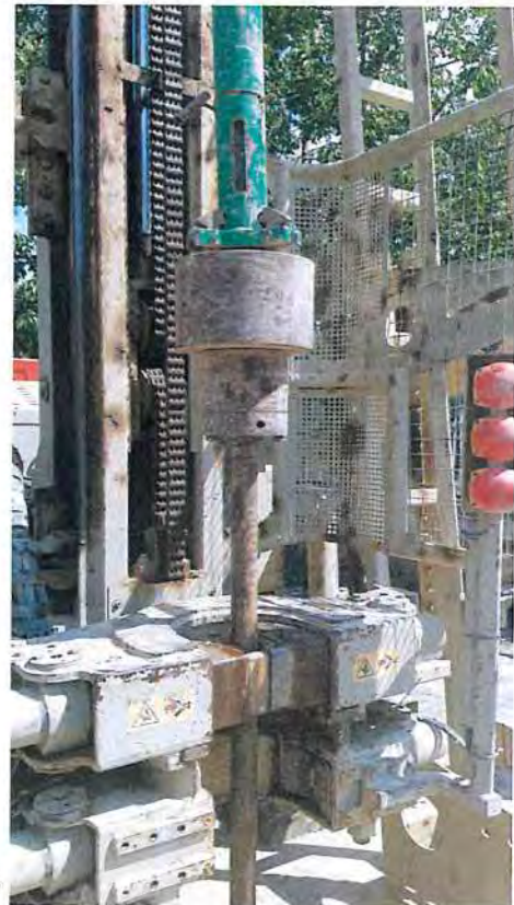
Esecuzione prova SPT
