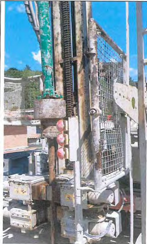
Esecuzione prova SPT
