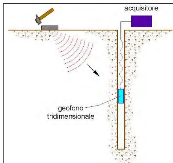
Figura 1 – Schema down hole ad un solo ricevitore
