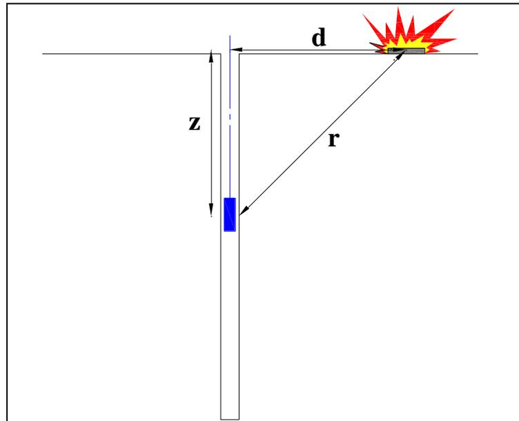
Figura 2 – Schema di down hole con metodo diretto
