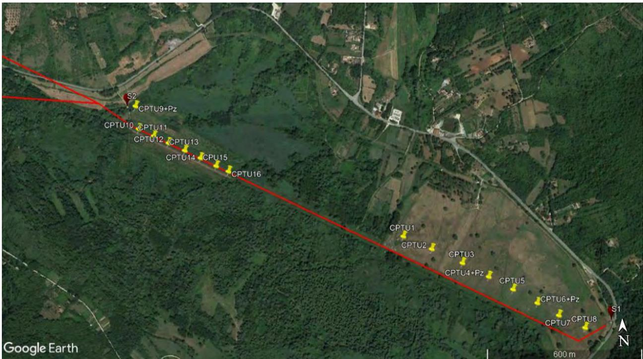
**Fig. 6.2.1:** Localizzazione delle prove CPTU 1-16 (piana di Mola di Regno e piana di Pantanto) e dei sondaggi geognostici S1 e S2 eseguiti in corrispondenza del Manufatto Origine e del Manufatto Nodo A.
