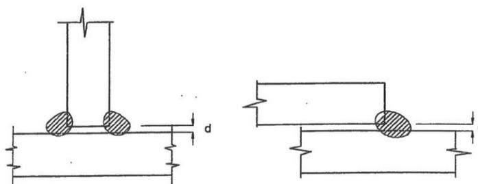
Qualora si verificano distacchi superiori a quelli sopra indicati, potrà essere prevista l'imbruttatura delle superfici per ripristinare la distanza corretta oppure potrà essere proposta ad ACEA una diversa preparazione dei lembi. Si dovrà tenere conto dell'eventuale necessità di incrementare le dimensioni dei cordoni d'angolo.
