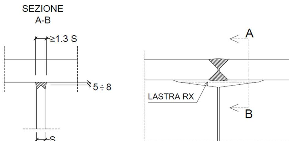
In ogni caso, in presenza di anime e/o piattabande saldate testa - testa, prima della composizione della trave, è necessario, dopo l'esecuzione dei prescritti controlli non distruttivi, spianare la zona di saldatura della piattabanda o dell'anima interessate, prima di assemblare gli elementi della trave per l'esecuzione delle saldature d'angolo per consentire la corretta aderenza
