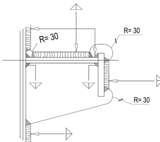
Qualora il Progettista non ritenga applicabile l'uso degli "scarichi" sopra indicati per problemi di fatica, si dovranno realizzare scarichi che seguano il profilo del cordone sottostante, con un distacco massimo di 1mm. In questo caso la saldatura delle nervature non verrà interrotta e seguirà il profilo dello scarico.
