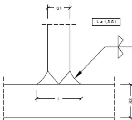
Per i giunti a T a parziale penetrazione l'angolo di apertura del cianfrino non dovrà essere inferiore a  $50^\circ$  e l'altezza della sezione resistente sarà assunta pari alla profondità del cianfrino  $g_{pp}$ .
