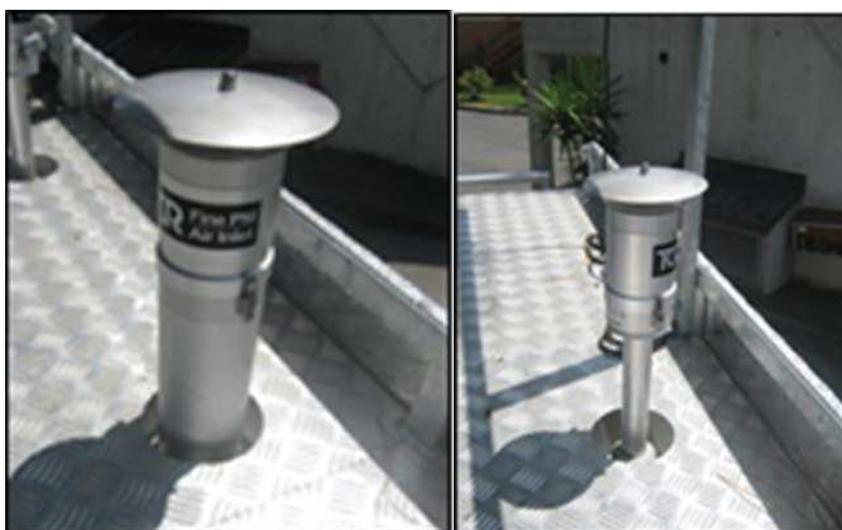
Figura 2-136 Teste di prelievo PM10 e PM2,5
