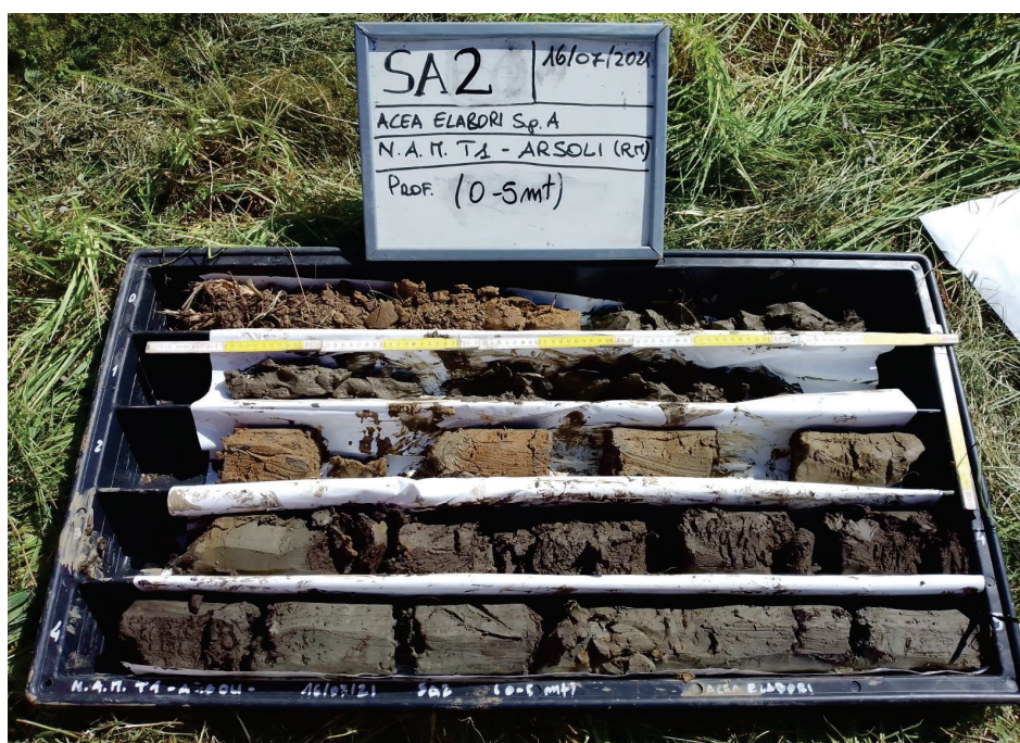
Figura 12: Foto della cassetta catalogatrice SA2 da 0 a 5 m dal piano campagna.
