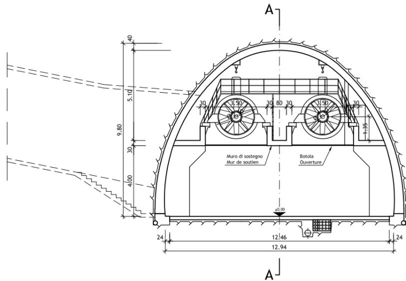
CENTRALE DI VENTILAZIONE "E/F" - Sezione C-C 1:100
