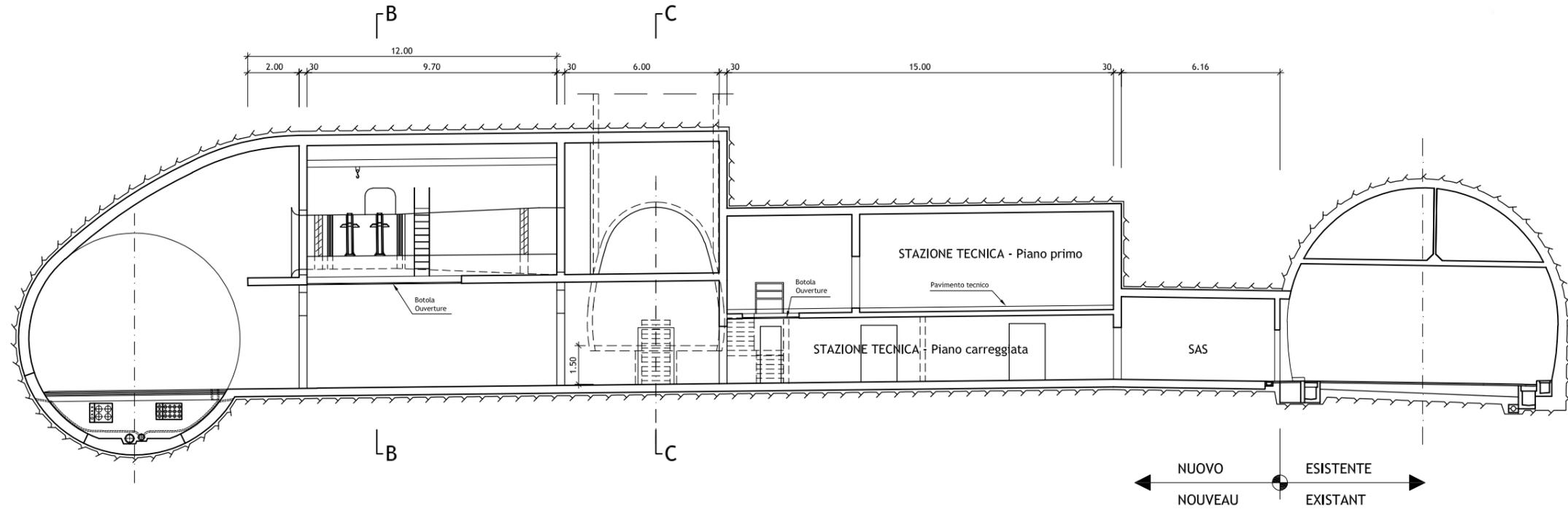
CENTRALE DI VENTILAZIONE "E/F" - Sezione B-B 1:100
