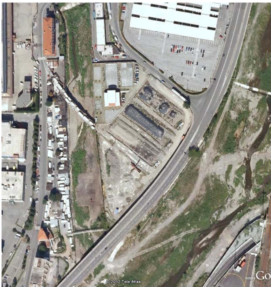
**Figura 9 Area Penisola nel 2005 con l’impianto di trattamento a biopile e l’area di stoccaggio (da Google Maps 2005)**
