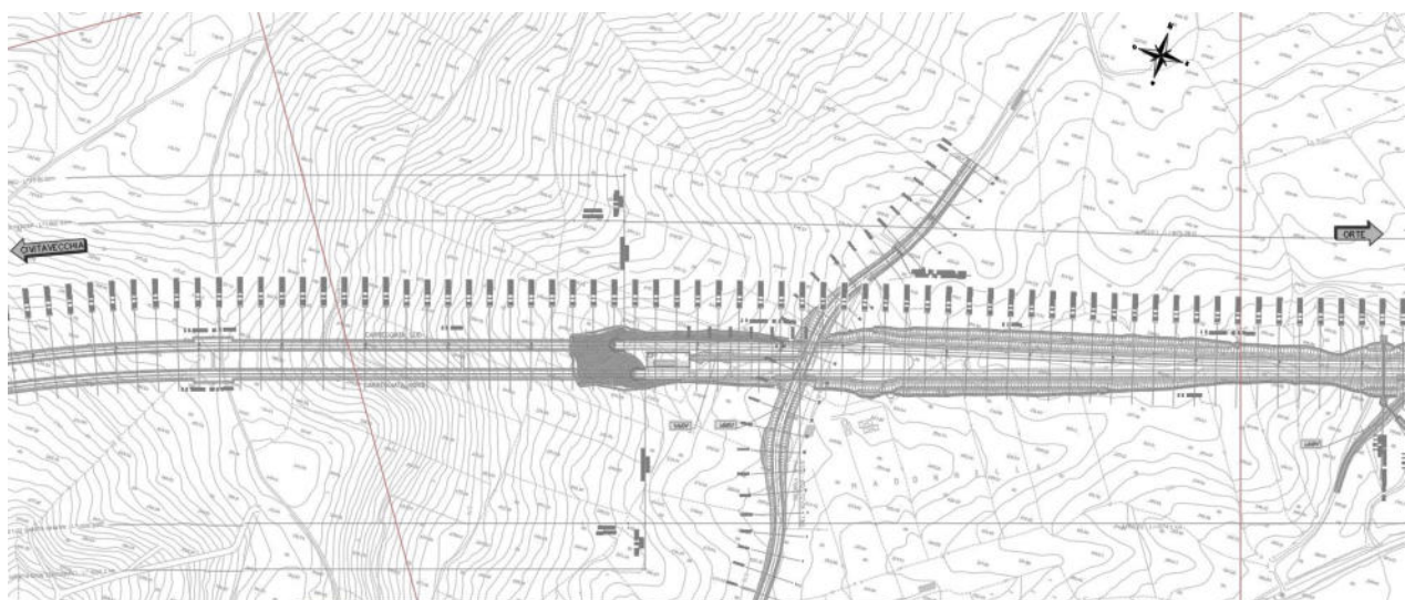
Figura 6: Stralcio planimetria inizio galleria Monteromano (L=1566,30m) e sottovia
