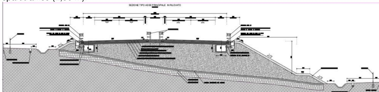
Figura 9: Sezione tipo in rilevato (asse principale)
