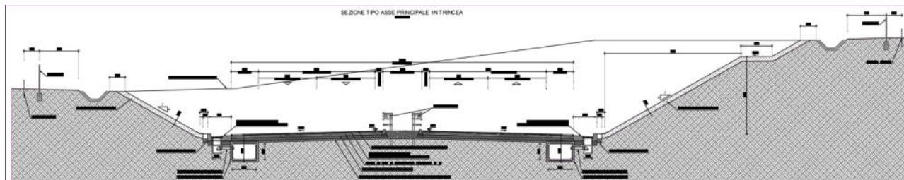
Figura 10: Sezione tipo in trincea (asse principale)
