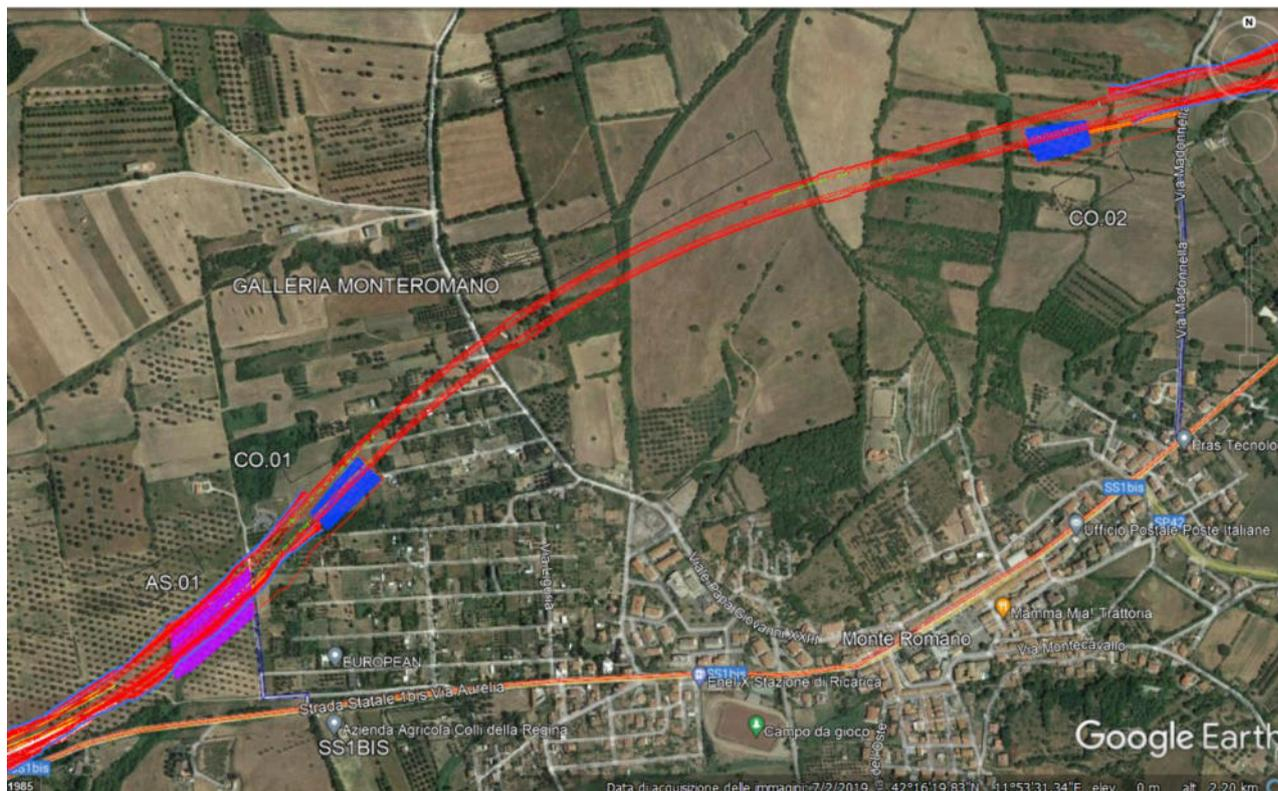
Figura 15: Aree di cantiere: cantieri operativi CO.01 e CO.02 agli imbocchi in galleria
