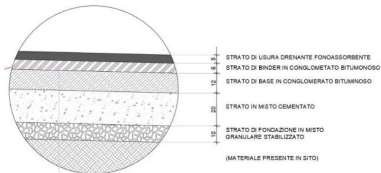
Figura 12: Dettaglio pacchetto stradale
