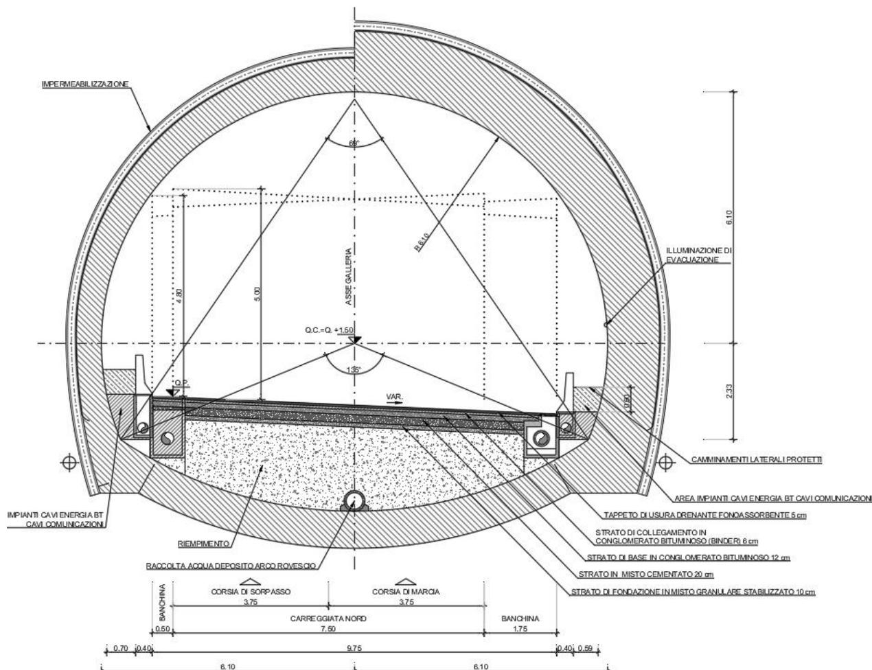
Figura 11: Sezione tipo in galleria (asse principale)
