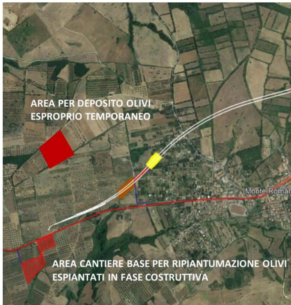
*Figura 4-8 - Vista aerea area di deposito temporaneo (rosso) olivi espiantati in fase costruttiva ed indicazione aree di cantiere, operative e stoccaggio lato ovest galleria Monte Romano*
