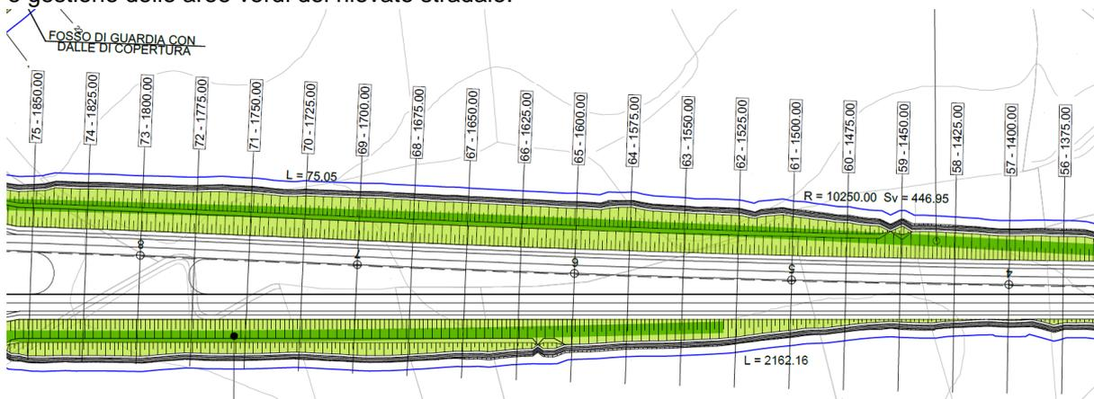
Figura 7-4- Sopra stralcio dalla planimetria di dettaglio interventi opere a verde di tratto in rilevato stradale di progetto superiore a 4 mt (da progr. 1+375,00 a 1+850,00).
