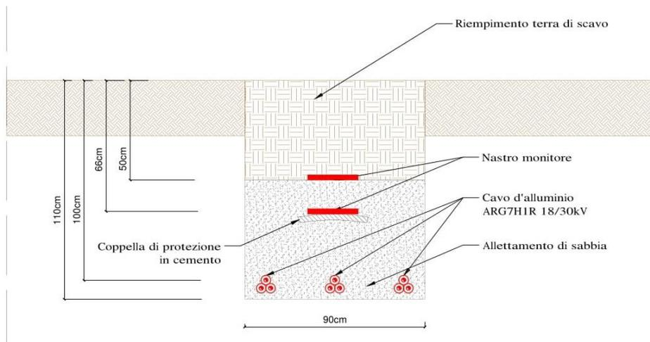
Figura 9.1: Modalità di Interrimento della Linea MT
