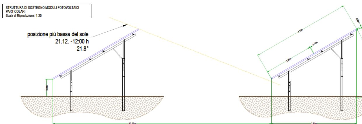
Figura 3.11: Esempio di Struttura di sostegno moduli fotovoltaici
