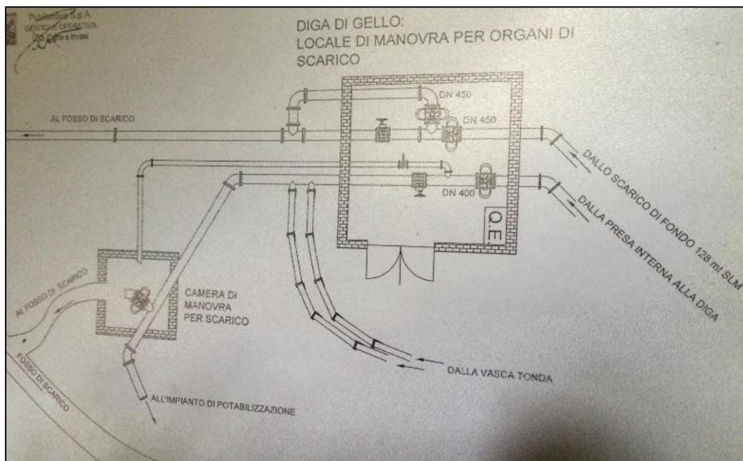
Figura 5-9 Schema di funzionamento degli organi di manovra dello scarico e derivazione
