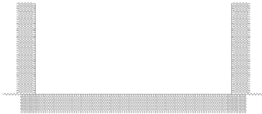
Figura 6-30 – Modellazione molle manufatto scatolare per ponte tipo I
