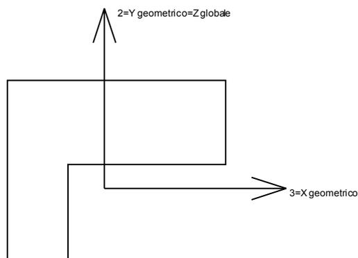
Nella figura si considera l'asse 1 entrante nel foglio (l'osservatore guarda in direzione coincidente a quella dell'asse 1). L'asse 2 è sempre verticale e quindi coincidente con l'asse Z globale nonché con l'asse y geometrico. L'asse 3 coincide con l'asse x geometrico. Si sottolinea il fatto che gli assi 2 e 3 non corrispondono agli assi principali della sezione.
