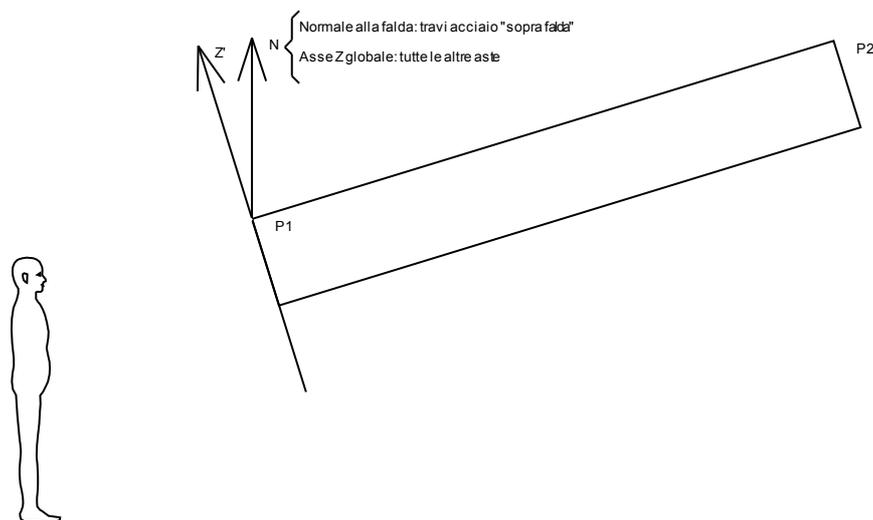
Z' è quindi l'intersezione tra il piano passante per P1, P2 contenente N e il piano della sezione iniziale dell'asta.
