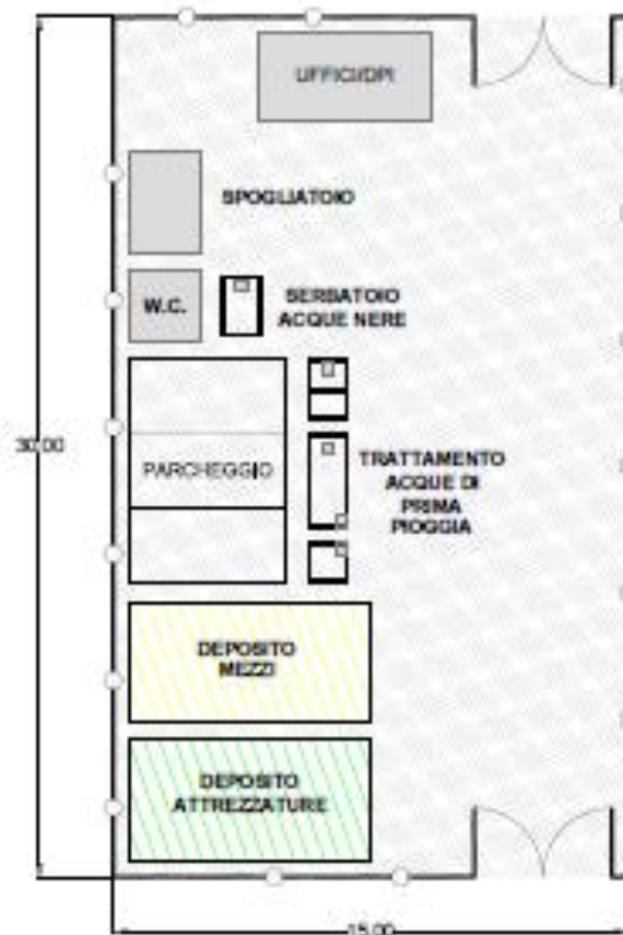
Figura 2-2 – Disposizione tipo cantiere base
