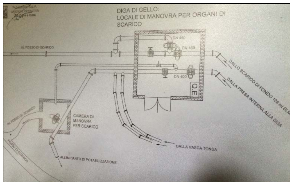
Figura 2-3: Schema di funzionamento degli organi di manovra dello scarico e derivazione.
