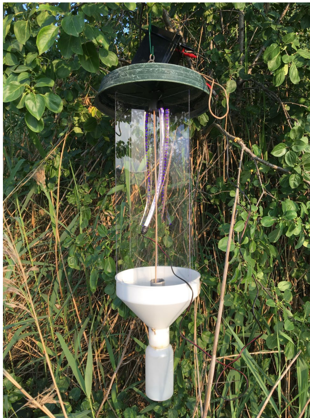
Fig. 6.1/A: Una delle trappole ad intercettazione per lepidotteri notturni con lampada UV alimentata da batteria a 12V utilizzata per il monitoraggio di E. quadripunctaria nel corso del 2021.
