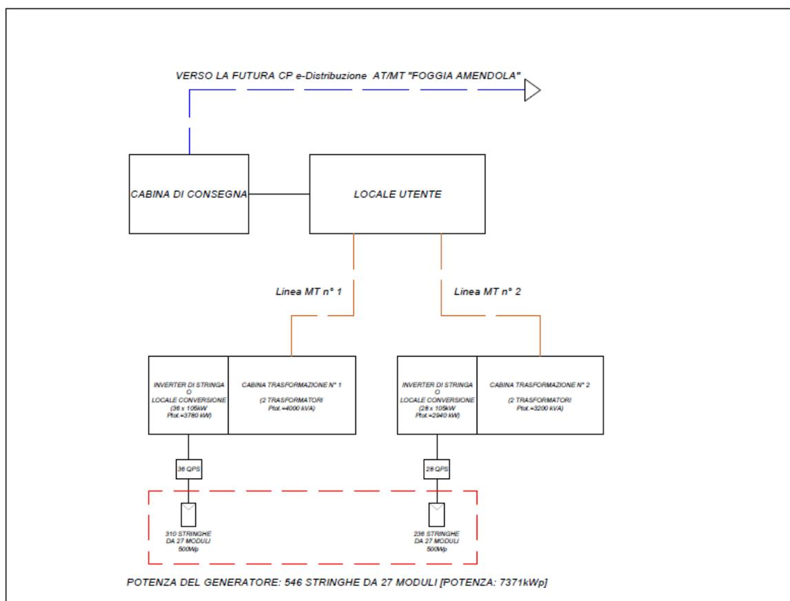
*Figura 12: schema a blocchi rappresentativo dell'impianto*
