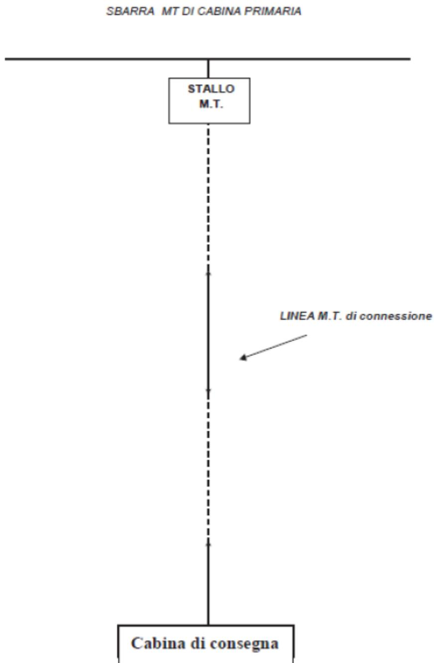
*Figura 2: Schema tipico di inserimento in antenna*
