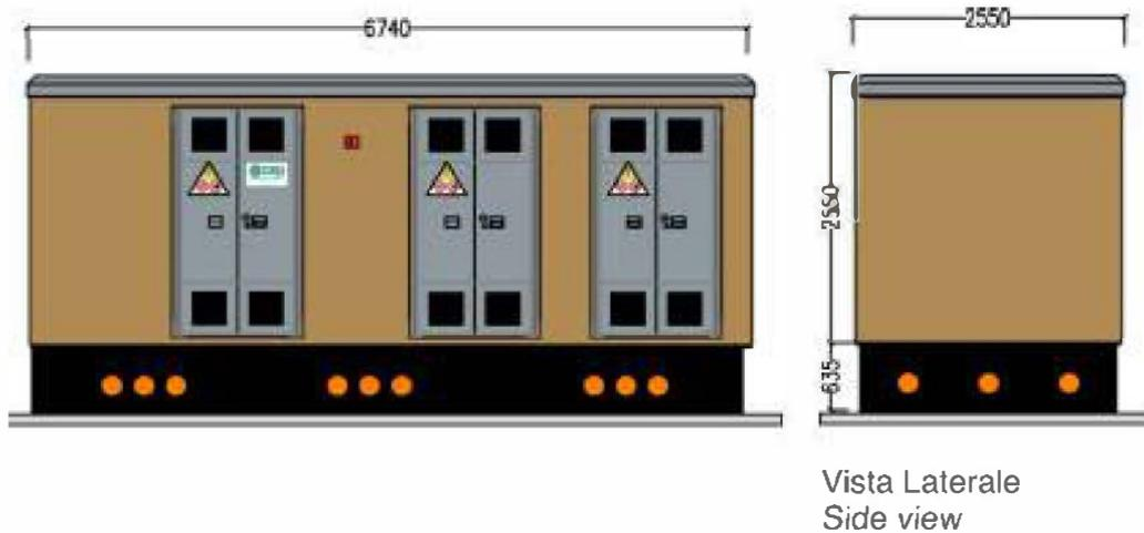
**Figura 6: vista laterale cabina elettrica di trasformazione**
