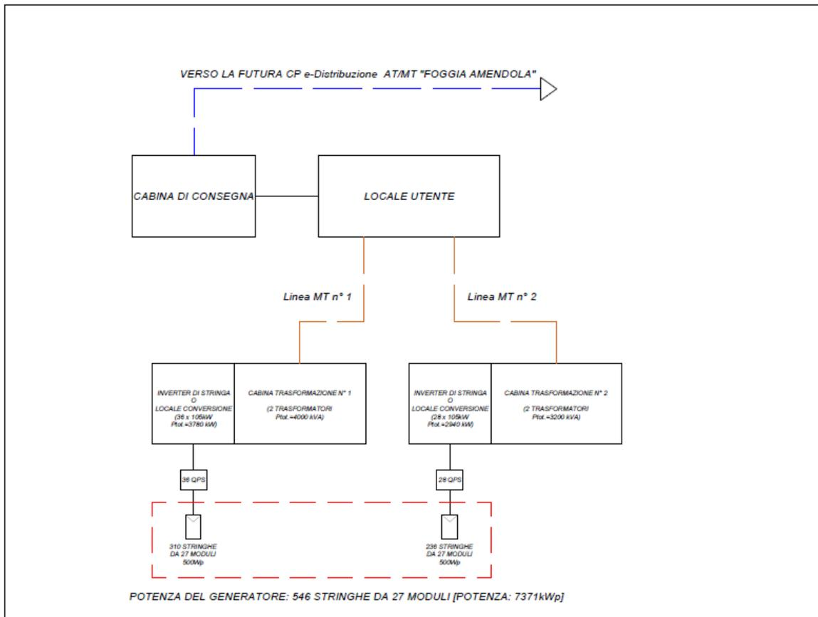
*Figura 3: schema a blocchi rappresentativo dell'impianto*
