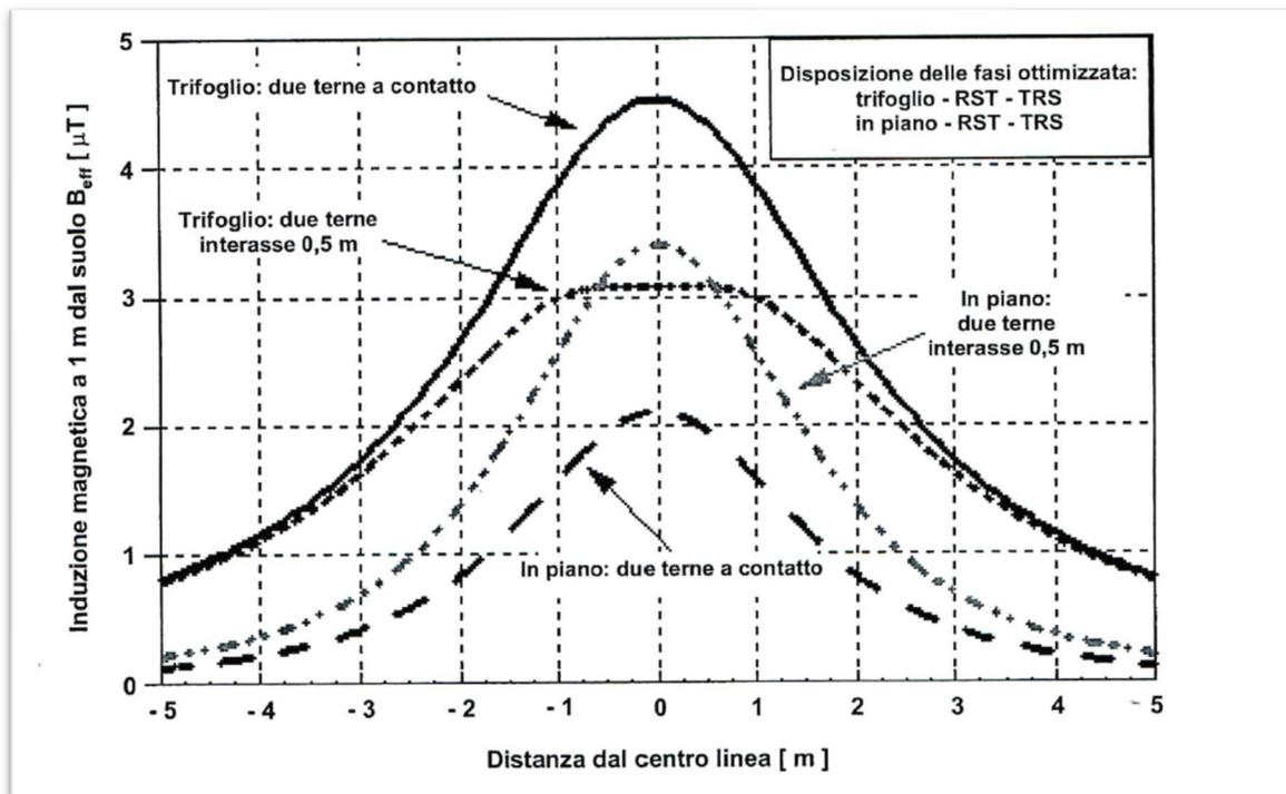
Figura 13: Confronto tra i profili laterali dell'induzione magnetica a 1 m da terra di due terne poste rispettivamente a trifoglio e in piano a contatto,  $I=1000$ ; profondità di posa= 1,2 m; diametro cavi 100 mm
