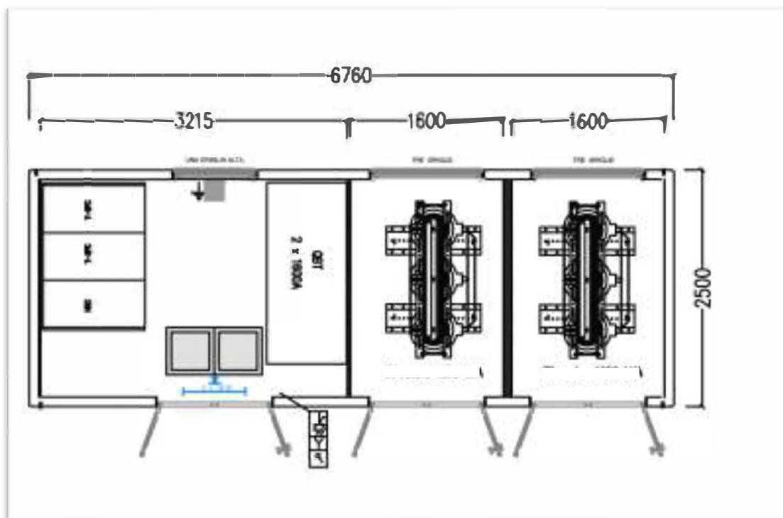
**Figura 7: vista in pianta cabine elettriche di trasformazione MT/BT**
