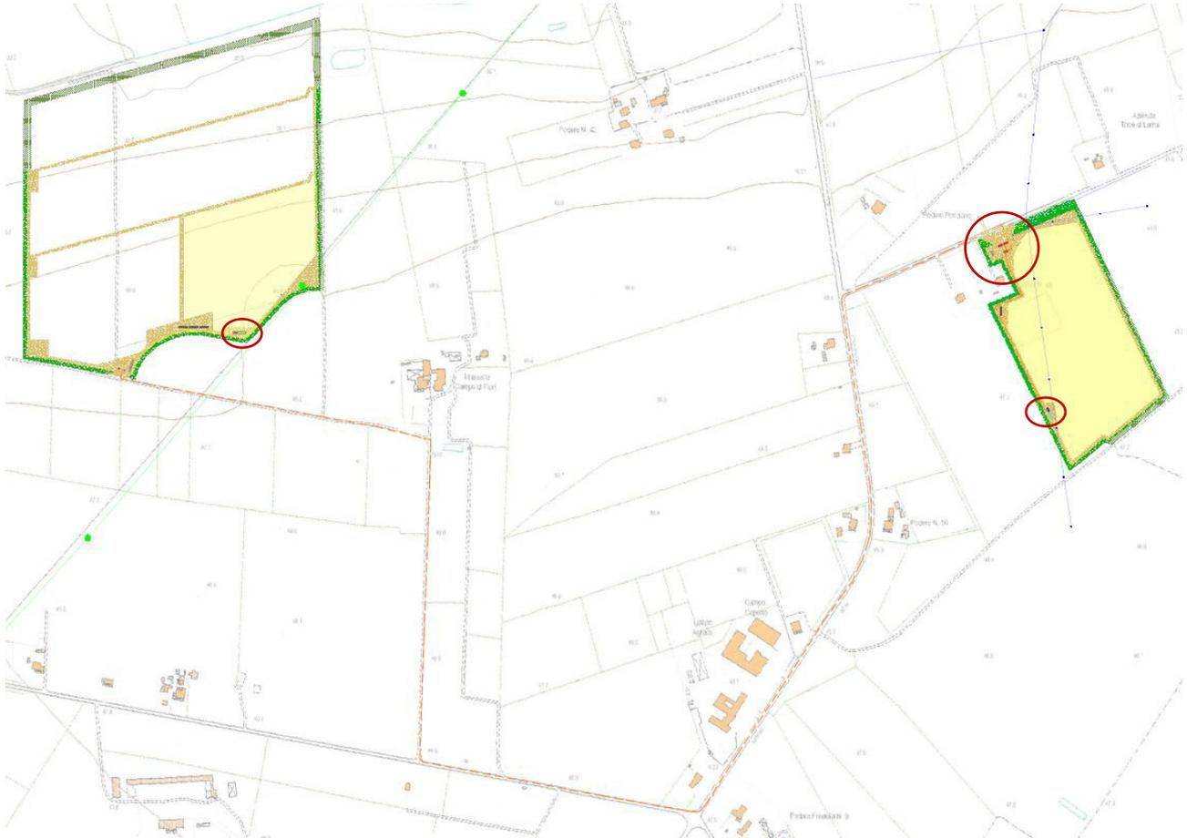
*Figura 10: Posizionamento cabine e tracciato cavidotto MT di Utenza - Torre di Lama 1*
