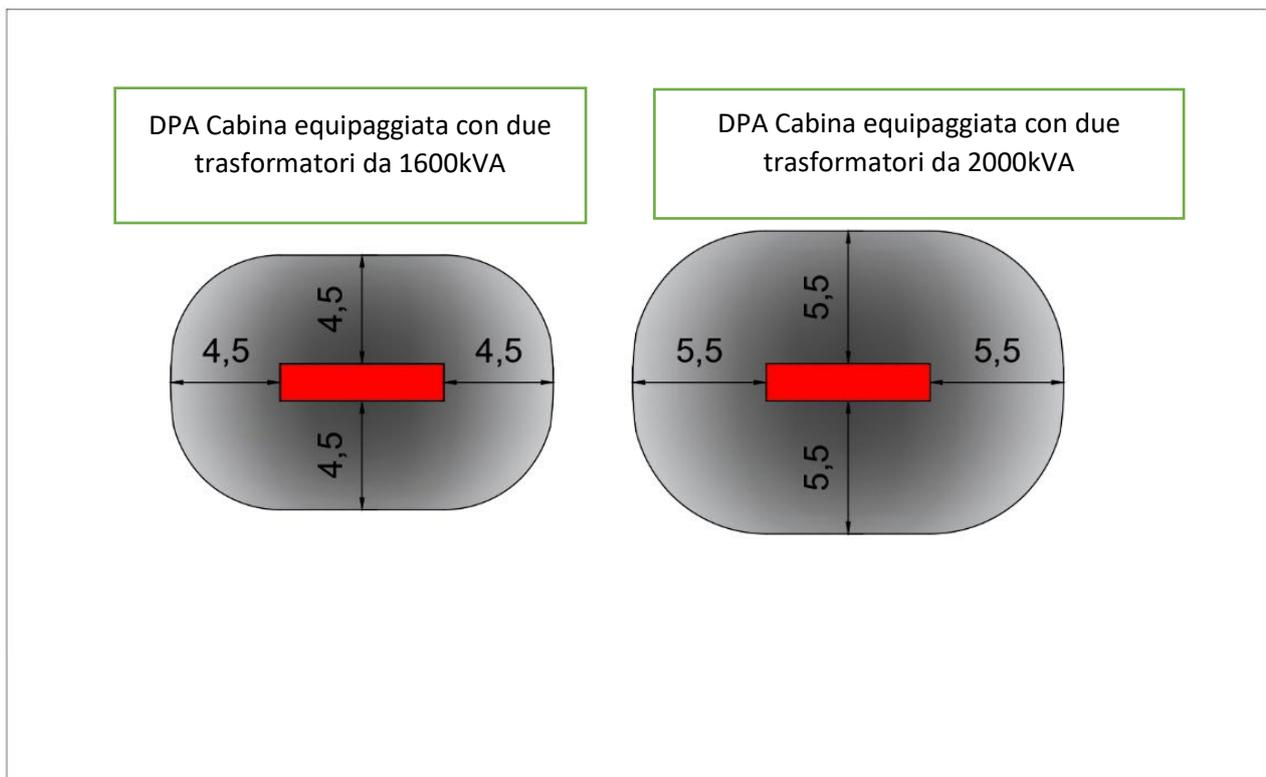
*Figura 9: indicazione della distanza di prima approssimazione di una cabina di trasformazione equipaggiata con trasformatori da 2000kVA e 2 trasformatori da 1600 kVA*
