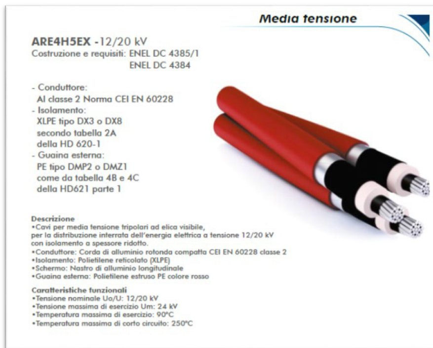
Figura 16: cavi MT ad elica visibile ARE4H45E 12/20kV per posa interrata
