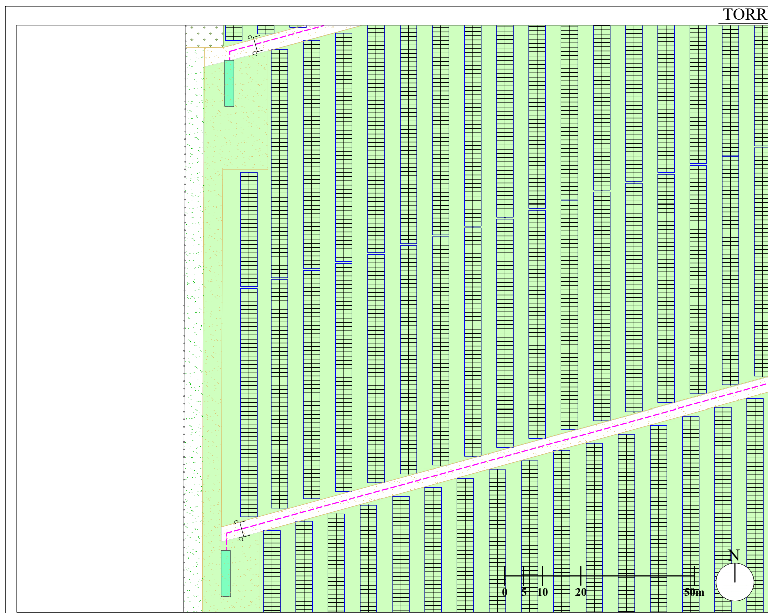
PARTICOLARE PLANIMETRIA TRACCIATO LINEE BT - TORRE DI LAMA 2 - SCALA 1:1000
