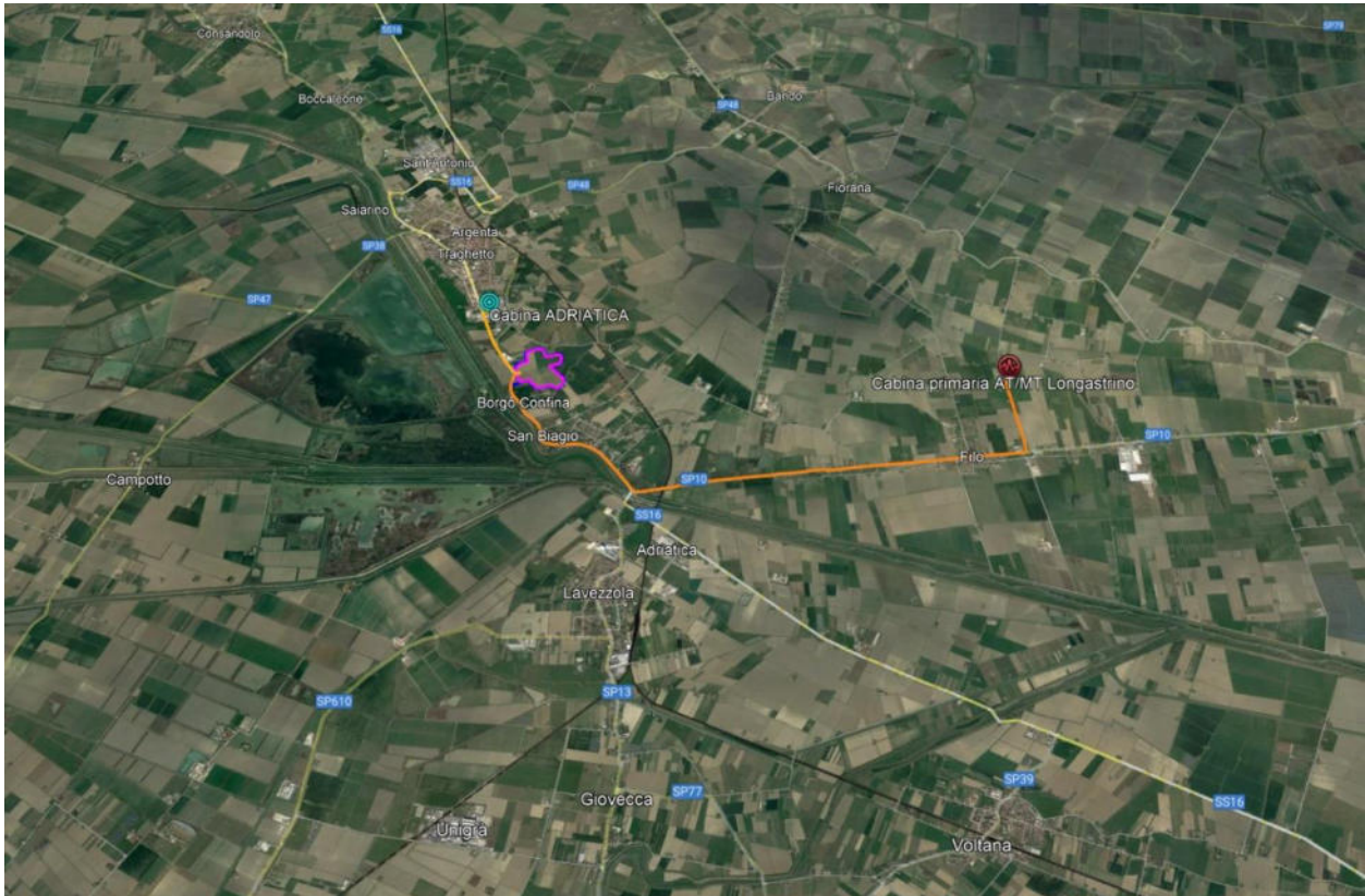
Figura 6. Localizzazione dell'area di intervento su foto satellitare: linea blu= superficie catastale; linea fucsia= area di impianto; linea arancione= cavidotto di connessione; puntalino rosso= cabina primaria AT/MT "Longastrino" e puntalino azzurro= cabina MT "Adriatica" (Fonte cartografica di base: Google Earth).
