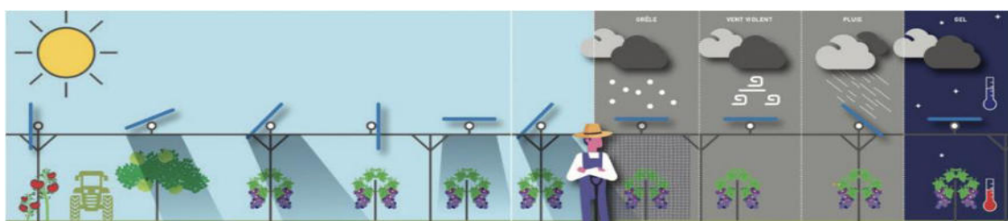
Figura 36. Illustrazione tipologica del funzionamento di un sistema Agrivoltaico (Fraunfer,2020).
