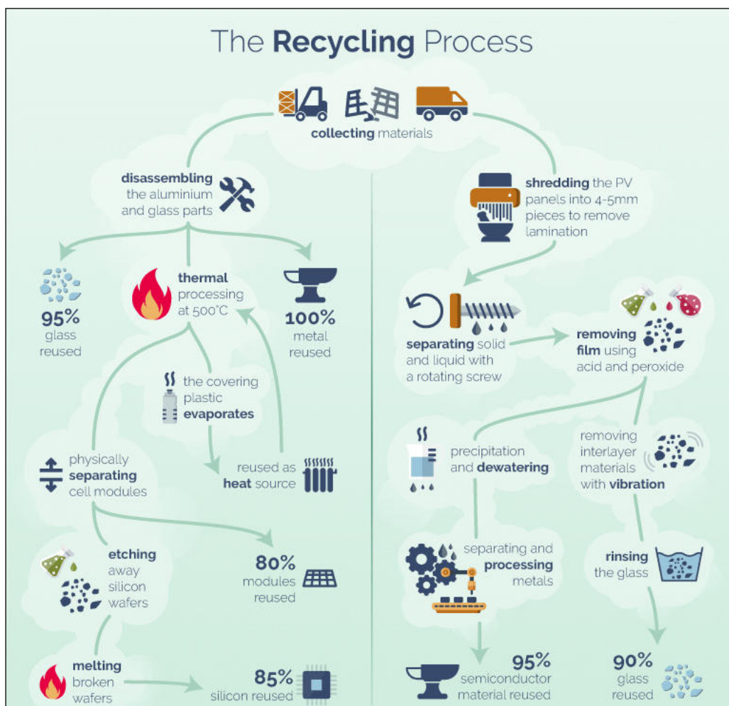
Figura 55. Il processo di riciclo dei moduli fotovoltaici a base silicea e dei sottoprodotti della dismissione di impianti fotovoltaici. Fonte: www.greenmatch.co.uk/blog/2017/10/the-opportunities-of-solar-panel-recycling (Ultimo accesso: febbraio 2020).
