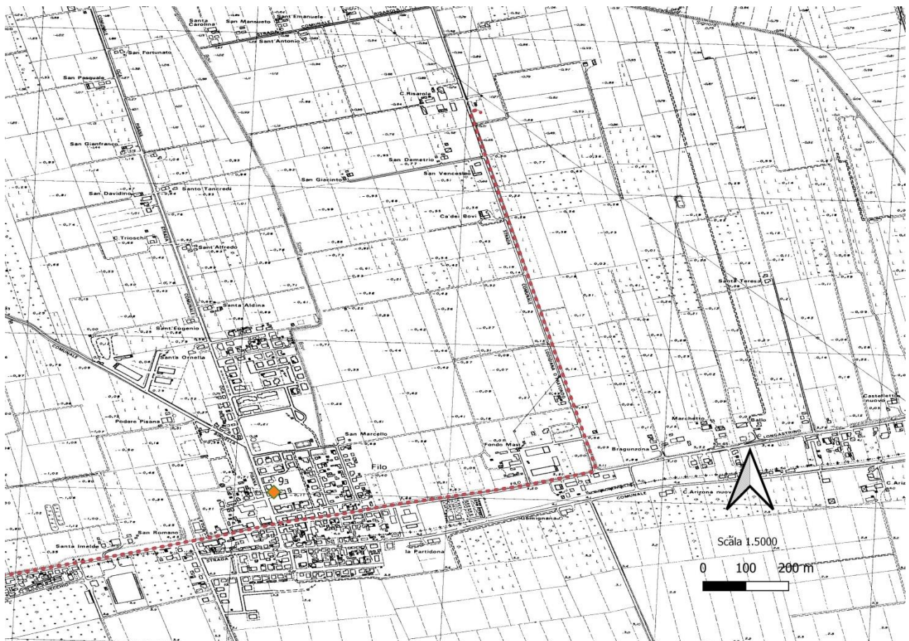
Figura 9 - stralcio cavidotto tratto terminale
