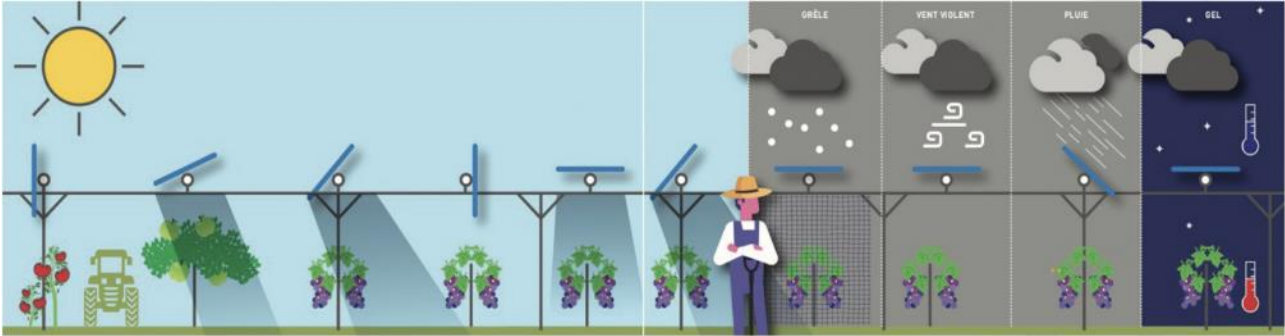
Figura 2. Illustrazione del funzionamento di un sistema agrivoltaico (Fraunhofer,2020).
