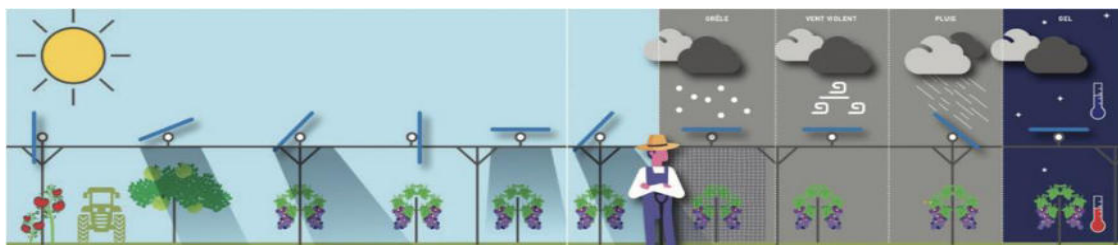
Figura 16. Illustrazione tipologica del funzionamento di un sistema Agrivoltaico (Fraunhofer,2020).
