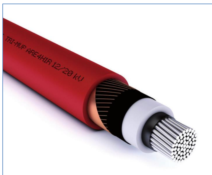
Immagine 14 – Cavo unipolare in alluminio per circuiti in Media Tensione 20 kV
