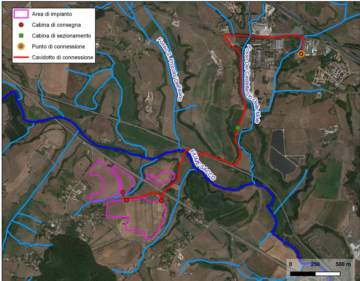
**Figura 23.** Dettaglio puntuale, ad elevata risoluzione, dei corpi idrici superficiali dell'area di indagine con indicate: i) l'area di impianto, ii) opere di rete e iii) le cabine di consegna / sezionamento ed il punto di connessione.
