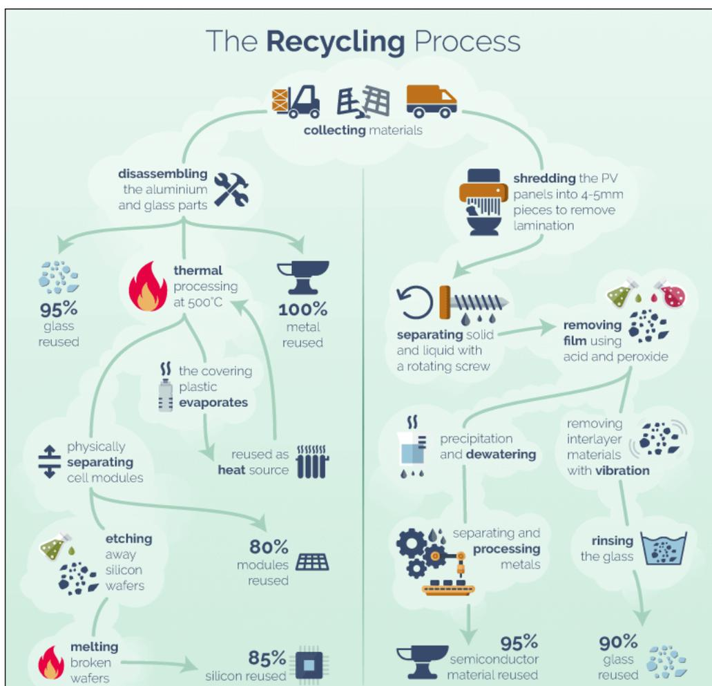
**Figura 48.** Il processo di riciclo dei moduli fotovoltaici a base silicea e dei sottoprodotti della dismissione di impianti fotovoltaici. Fonte: [www.greenmatch.co.uk/blog/2017/10/the-opportunities-of-solar-panel-recycling](http://www.greenmatch.co.uk/blog/2017/10/the-opportunities-of-solar-panel-recycling) (Ultimo accesso: marzo 2021).
