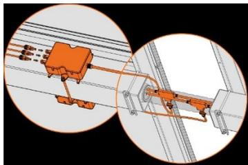
La rotazione dell'asse orizzontale del tracker sarà assicurata da un motore elettrico gestibile anche attraverso il sistema Wi-Fi per limitare il numero dei cavi elettrici.
