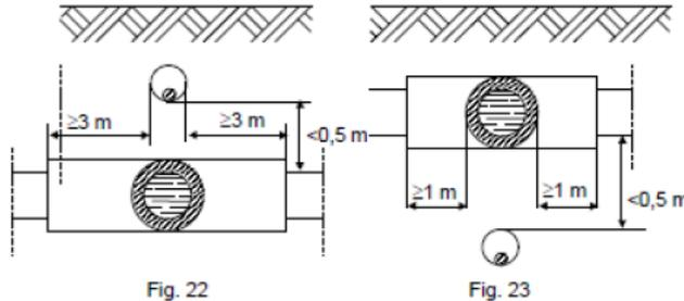
Nei casi di percorsi paralleli tra canalizzazioni per cavi elettrici e tubazioni del gas la distanza misurata tra la due superfici affacciate deve essere:
