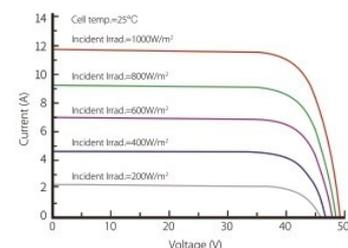
*Modulo fotovoltaico – parametri elettrici*
