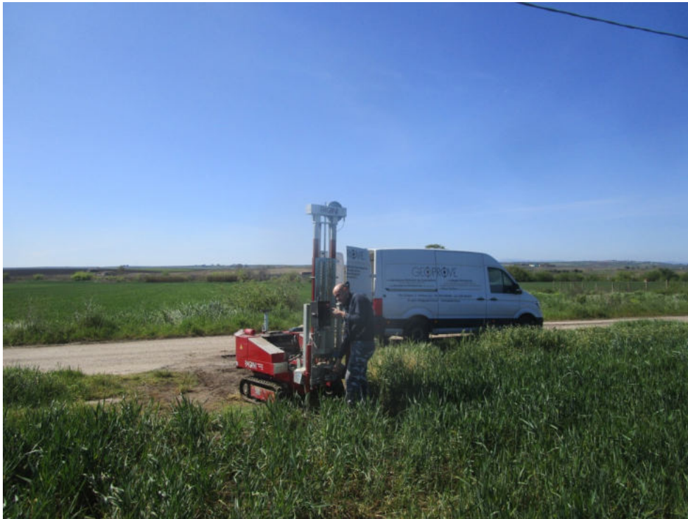
Esecuzione prova penetrometrica dinamica continua DPSH n.1
