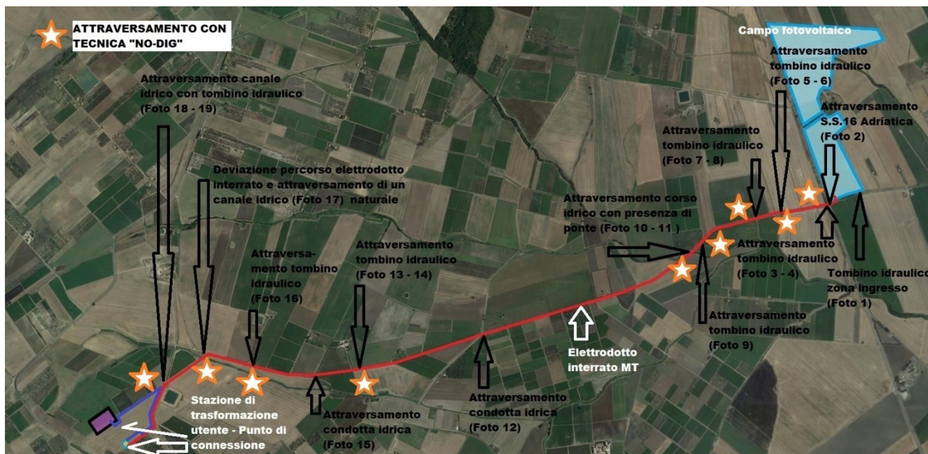
Planimetria degli attraversamenti con tecnica "No-dig"
