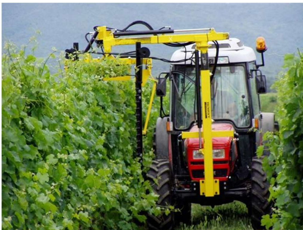
Figure 8-43. L'immagine evidenzia una trattrice gommata convenzionale con braccio per le opere di "profilatura" delle siepi.
