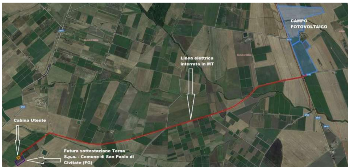
Figure 6-29. Vista d'insieme dell'impianto con collegamento cavo MT (in rosso).
