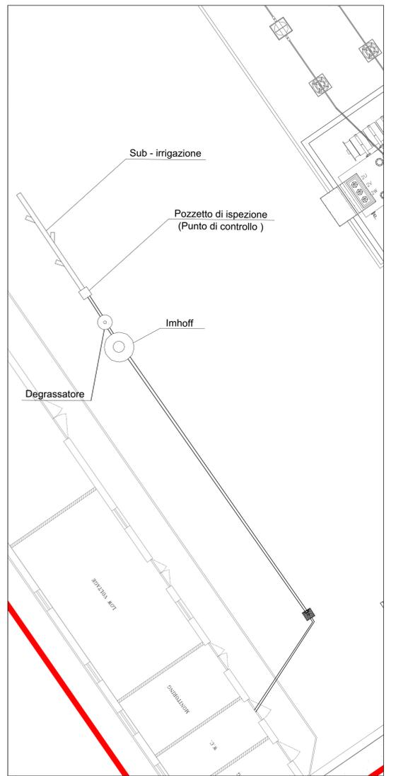
PARTICOLARI SISTEMA DI TRATTAMENTO REFLUI - Scala 1:100
