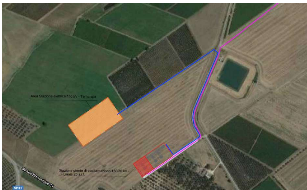
Illustrazione 1.4: Vista d'insieme della stazione utente con collegamento cavo AT
