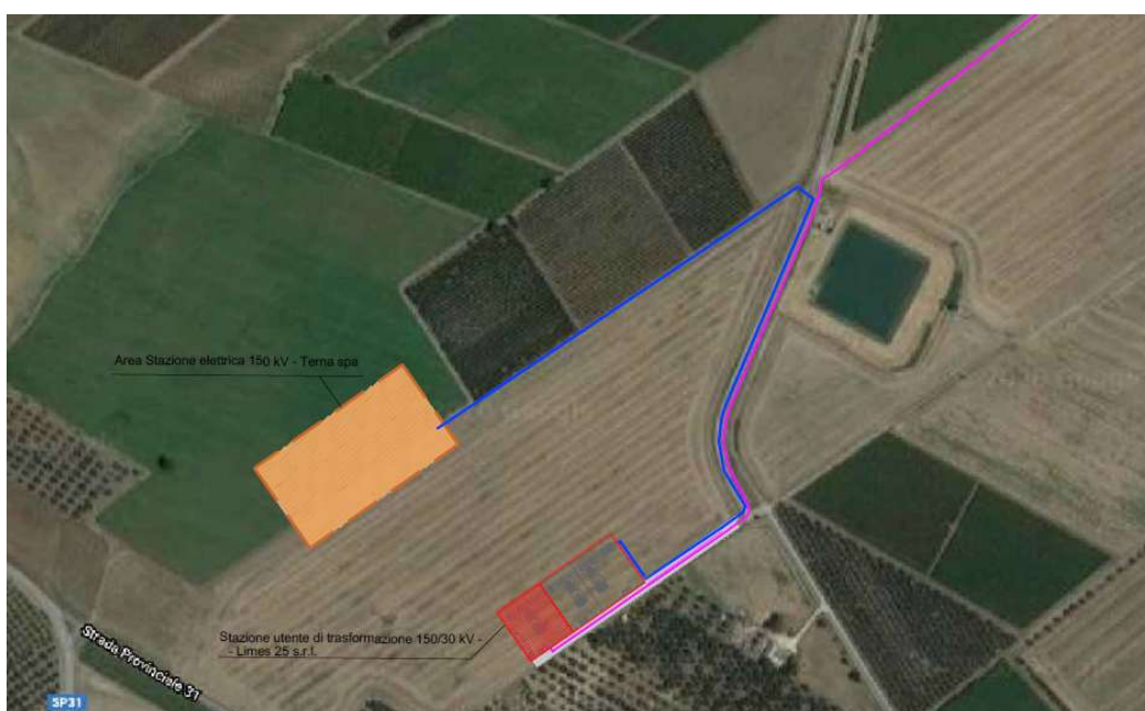
Illustrazione 3.6: Vista d'insieme della stazione utente con collegamento cavo AT
