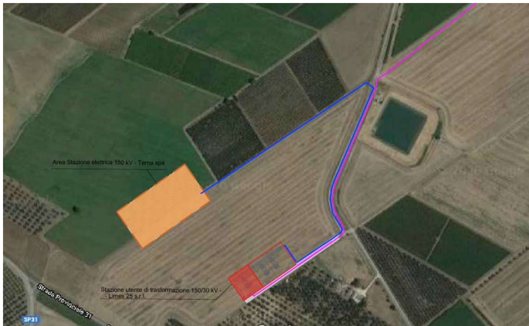
Illustrazione 6.1: Vista d'insieme della stazione utente con collegamento cavo AT
