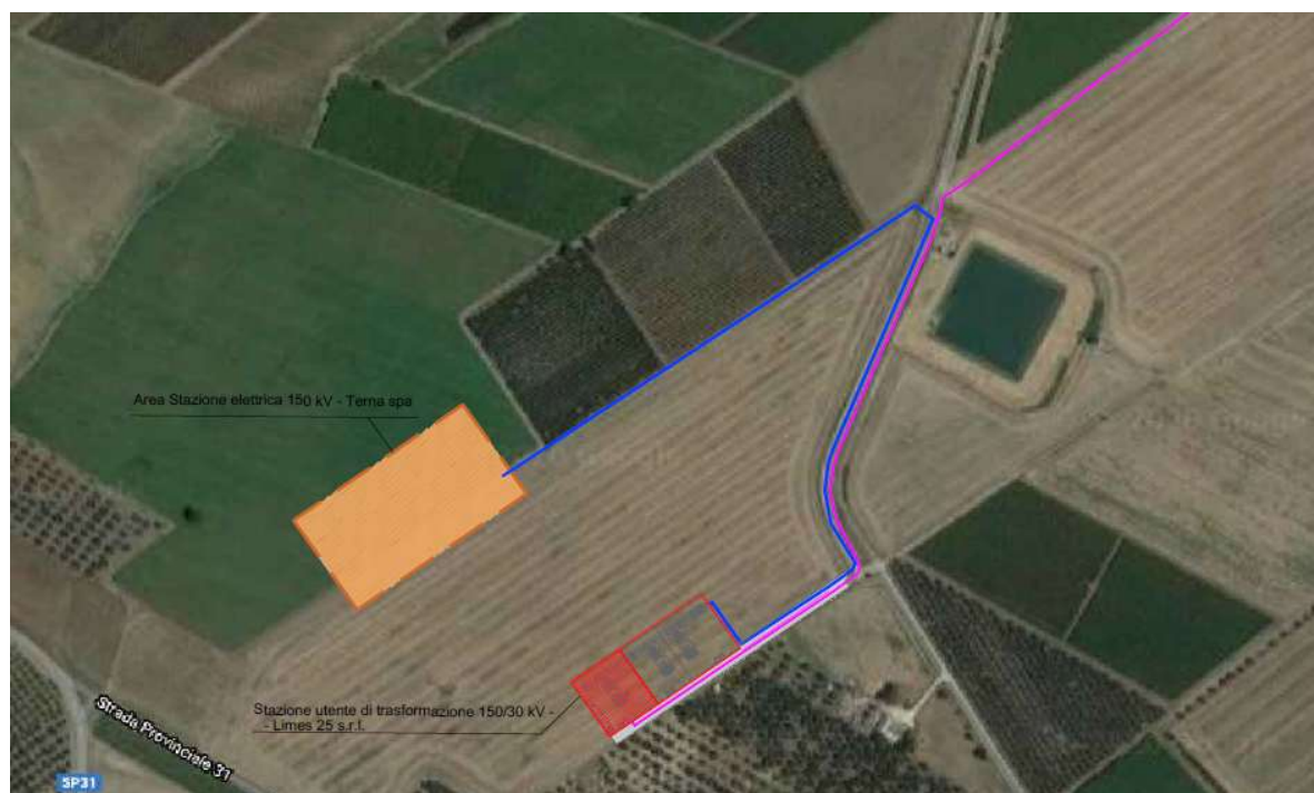
Illustrazione 6.30: Vista d'insieme della stazione utente con collegamento cavo AT
