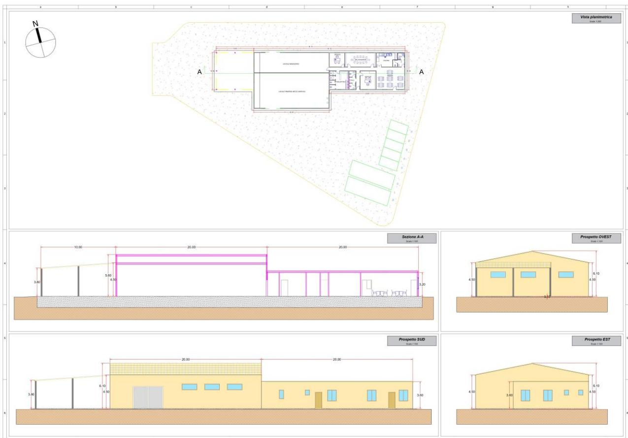
Figura 19 – Vista planimetrica e particolari sala controllo e magazzino
