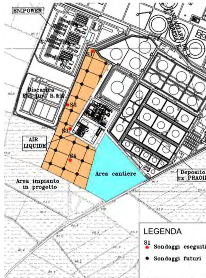
Figura 5: Planimetria del sito con ubicazione dei sondaggi realizzati nel mese di Giugno 2008
